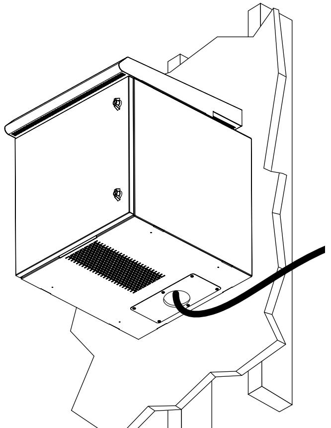
**Remarque :** Pour garder une capacité nominale NEMA, utiliser des raccords étanches dans les découpes au moment de connecter à la conduite. Les plaques passe-câbles pour accessoires avec les numéros de modèle SRGP1KO, SRGP2KO, SRGP3RM et SRGP4PLASTIC sont offertes (vendues séparément).
