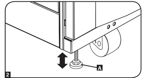
**3** Después de bajar cada nivelador, use el nivel de carpintero para confirmar que el estante está nivelado en todas las direcciones. Ajuste los niveladores hasta que el estante esté nivelado.
