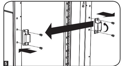
**6** Desatornille el mecanismo de 2 bisagras de las aperturas de las bisagras en el interior de la puerta, y luego fije cada una de ellas usando el juego de perforaciones inmediatamente opuesto a la posición original.
