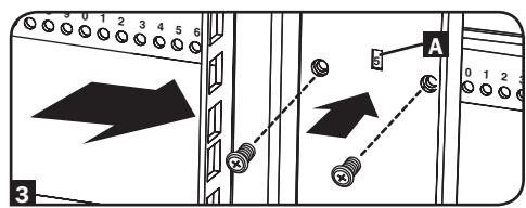
**El fondo de los 2 rieles para el manejo de cables pueden ajustarse usando el mismo método.**
