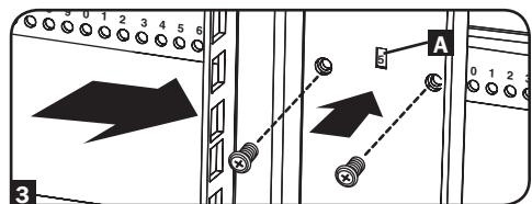
**La même méthode permet d'ajuster la profondeur des 2 profilés pour les chemins de câbles.**
