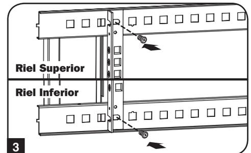
**4** Use los tornillos plateados de instalación, incluidos, para asegurar su equipo al riel del rack. Coloque las arandelas de seguridad entre los tornillos y las ménsulas de instalación del equipo.
