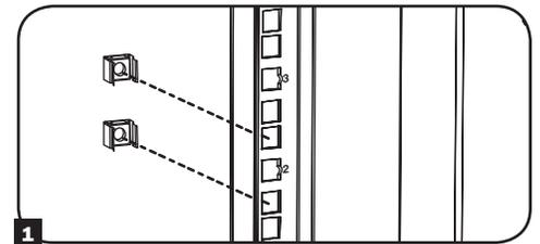
**2** Desde la parte interior del riel de instalación, inserte una de las bridas de la tuerca de fijación a través de la abertura cuadrada. Oprímala hacia el costado de la abertura cuadrada. Cada brida debe acoplar en un costado de la abertura cuadrada, no en la parte superior o inferior.
