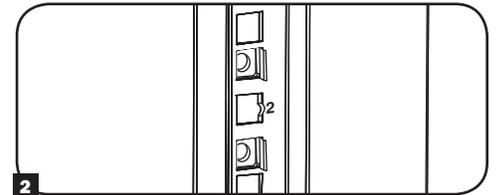
**3** Comprima la tuerca de fijación ligeramente por los costados para permitir que el resto de la brida se acople a través de la abertura cuadrada. Cuando la tuerca de fijación esté instalada correctamente, ambas bridas deben sobresalir a través de la abertura cuadrada y ser visibles sobre la superficie exterior del riel de instalación. Repita los pasos 1-3 hasta que estén instaladas todas las tuercas de fijación necesarias.
